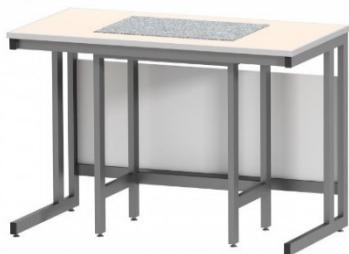
За счет полированного гранита, расположенного на демпферной подложке, и цельносварного каркаса весовой противовибрационный стол обеспечивает необходимые условия при работе с весами повышенной точности.
